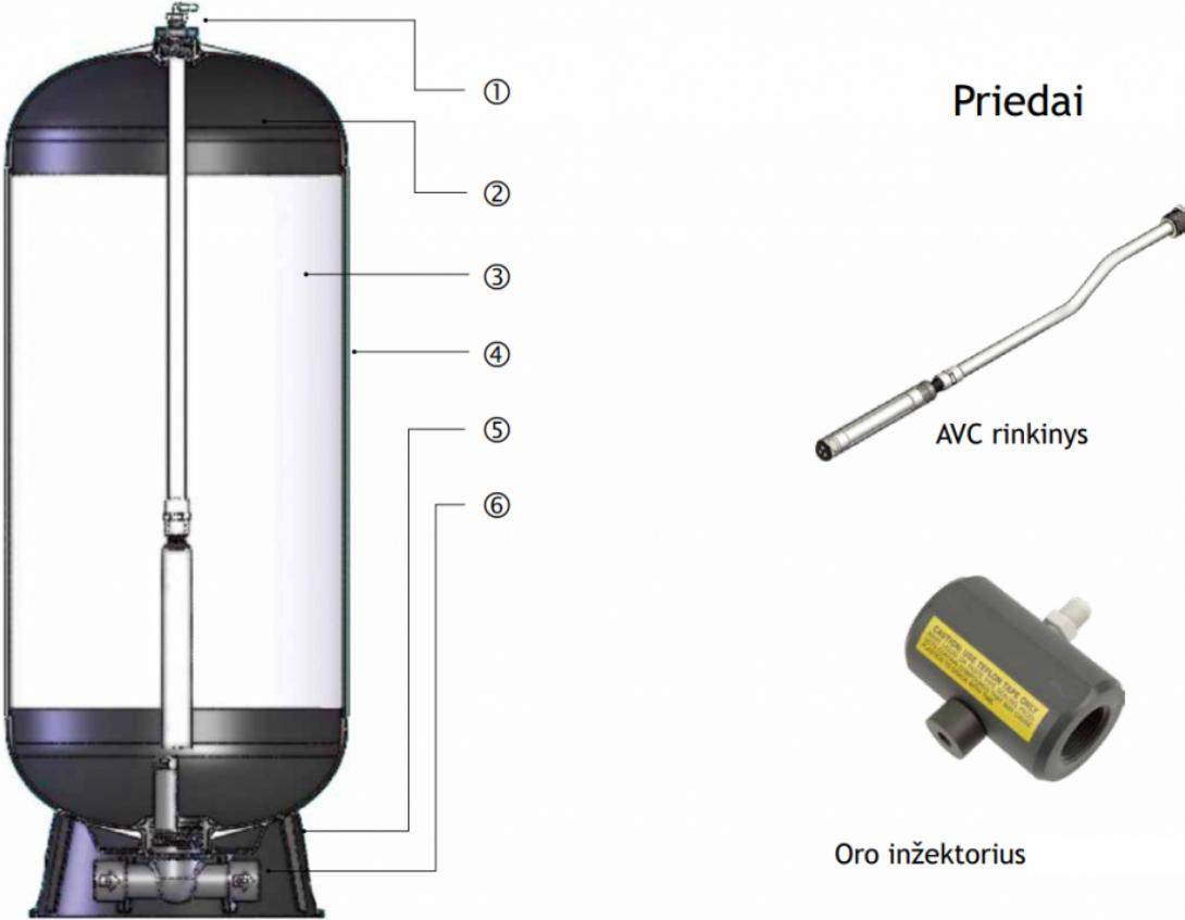
1. Viršutinė anga: stiklo pluoštas ir nerūdijantis plienas, sustiprinto polipropileno įdėklas, įlietas viršutiniame kupole
