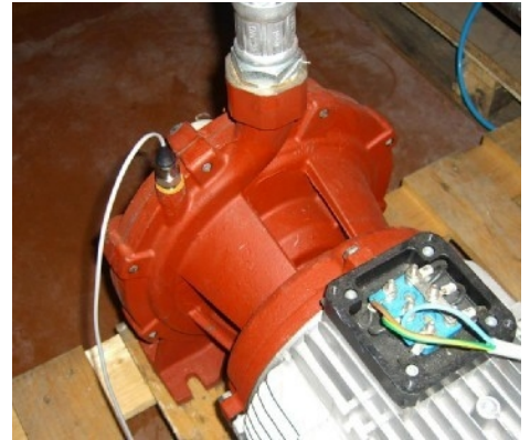
3 pav: siurblio padavimo linijos užpildymo angos su prijungtu keitliu pavyzdys
