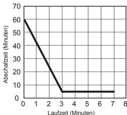
Abbildung 1: Autom. nachjustierte Erholungszeit nach Trockenlauf
