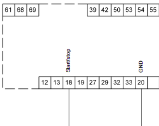
22 pav. Būtinai minimalus signalų gnybtų prijungimas
