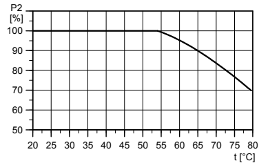
13. pav. Galios sumažinimas pagal aplinkos temperatūrą
