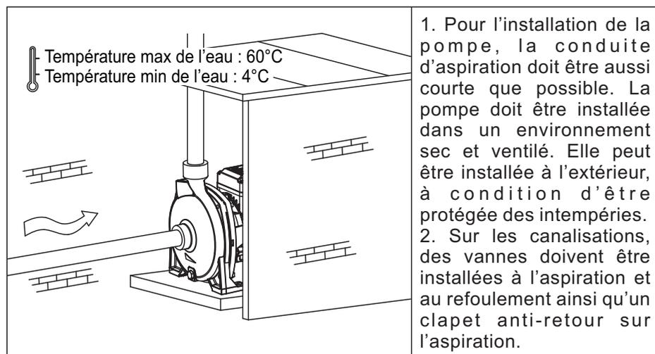
1. Pour l'installation de la pompe, la conduite d'aspiration doit être aussi courte que possible. La pompe doit être installée dans un environnement sec et ventilé. Elle peut être installée à l'extérieur, à condition d'être protégée des intempéries.
