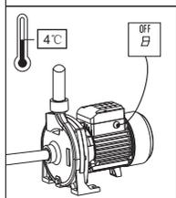
6. Dans le cas où la température ambiante est inférieure à 4°C ou lorsque la pompe n'est pas utilisée pendant un long moment, vidanger la pompe pour éviter que le gel détériore le corps de pompe.
