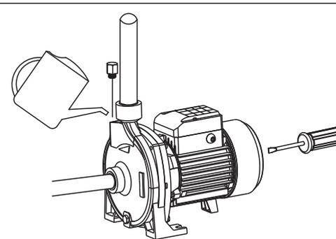
Faire tourner les pales de ventilateur avant le démarrage, afin de vérifier que la rotation est facile et avant de dévisser le bouchon d'amorçage et de remplir le corps de pompe avec de l'eau claire ; resserrer le bouchon après avoir extrait tout l'air. La vanne doit être ouverte lors du démarrage de la pompe.
