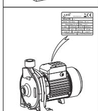
9. L'alimentation électrique doit être conforme à la tension électrique spécifiée sur la plaque signalétique du moteur. Si elle n'est pas utilisée pendant un long moment, stocker la pompe dans un endroit sec et ventilé.
