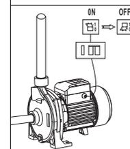
2. La pompe électrique doit être reliée correctement à la terre afin d'éviter tout court-circuit ; pour des raisons de sécurité, l'installation devra être équipée d'un disjoncteur magnétothermique correctement calibré.
