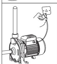
8. S'assurer que la pompe ne peut pas être accidentellement alimentée pendant son installation et sa maintenance ; si elle n'est pas utilisée pendant un certain temps, couper son alimentation et fermer les vannes à l'aspiration et au refoulement.
