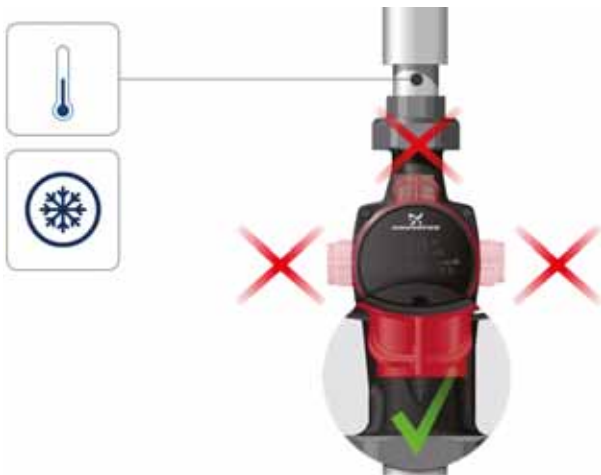
4. pav. Valdymo dėžutės padėtis oro kondicionavimo ir šalto vandens sistemose
