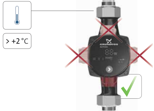
4. pav. Valdymo dėžutės padėtis oro kondicionavimo ir šalto vandens sistemose
