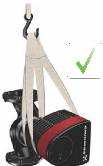
5. pav. Teisingas siurblio kėlimas
