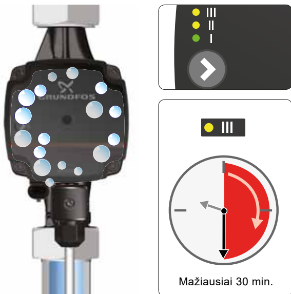
7. pav. Oro išleidimas iš siurblio
