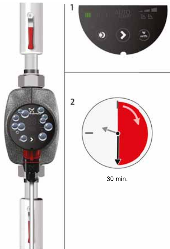
8. pav. Oro išleidimas iš siurblio
