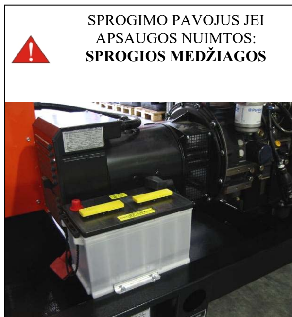
Pav. 6: Akumuliatoriaus baterija be apdangalo
