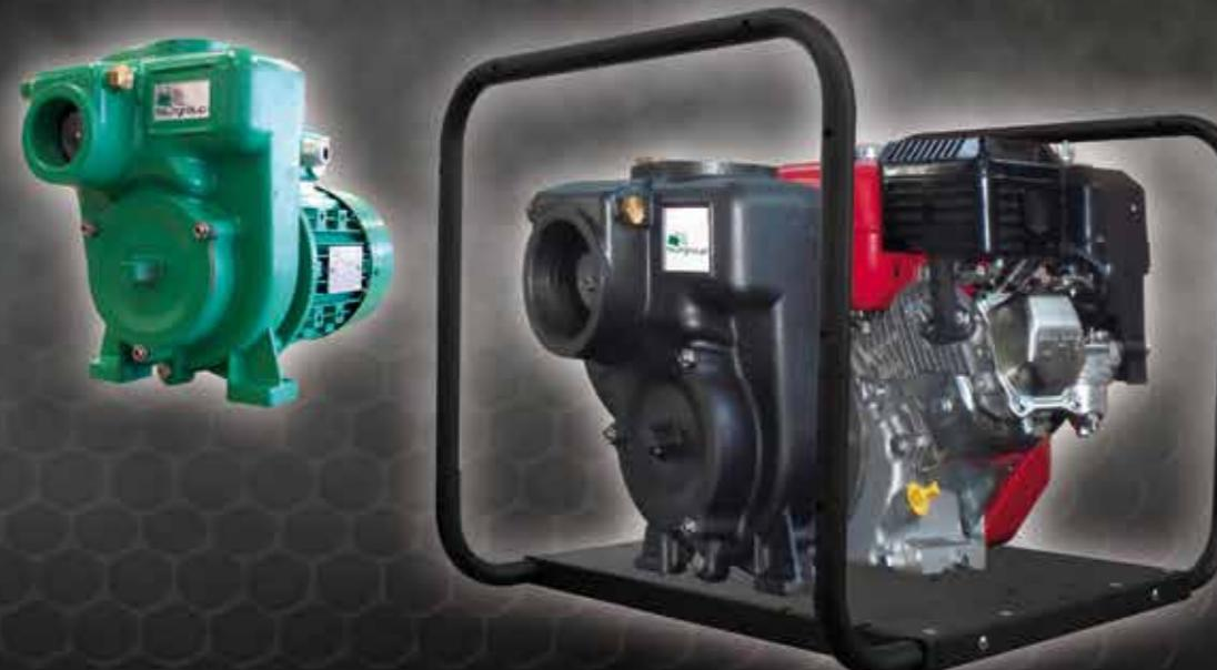
Motopompe autoadescenti monoblocco a girante aperta destinate a trattare sia acque chiare che acque scure. Disco d' usura in acciaio inox AISI 316 e girante in ghisa sono estraibili direttamente dal portello di ispezione. Motore benzina o diesel, progettata per pompare liquidi sporchi anche con corpi solidi in sospensione. Qualità e robustezza le rendono adatte anche per lavori continuativi, ideali per l'irrigazione, sottopassi o scavi di cantiere e come emergenza allagamento.
