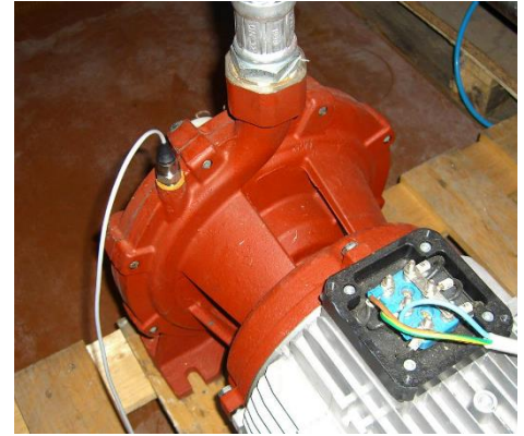
4 pav. Siurblio užpildymo angos pavyzdys su sumontuotu slėgio jutikliu
