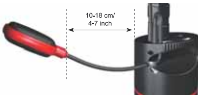
4. pav. Minimalus laisvos plūdinio jungiklio kabelio dalies ilgis
