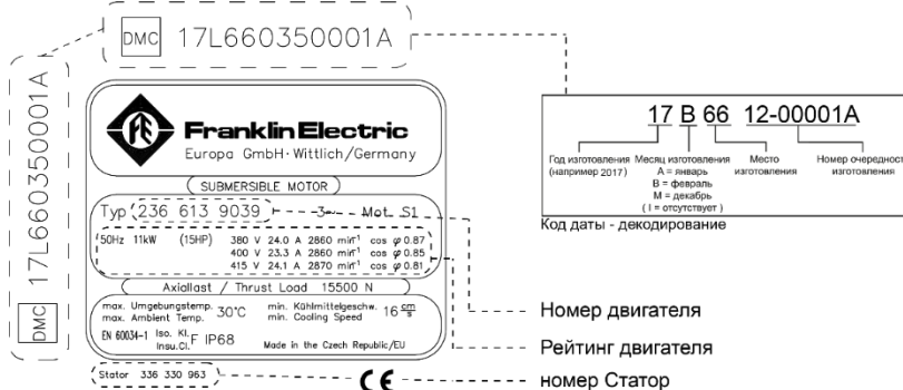
Рис. 5-1: фирменная, заводская табличка с данными по сроку выпуска
