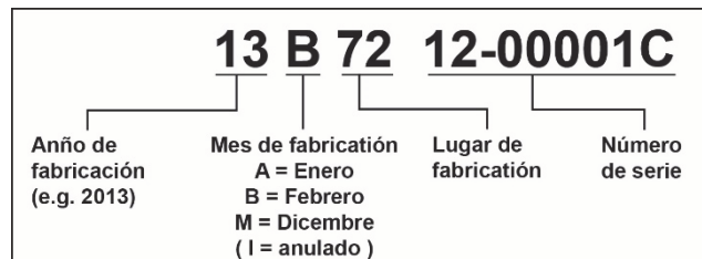
Ilustración 5-1: Placa de características con datos de fabricación
