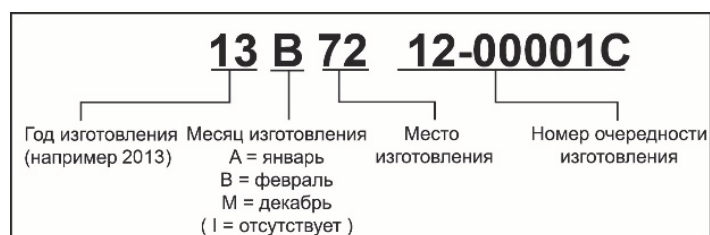
Рисунок 5-1: Фирменная, заводская табличка с производственными данными
