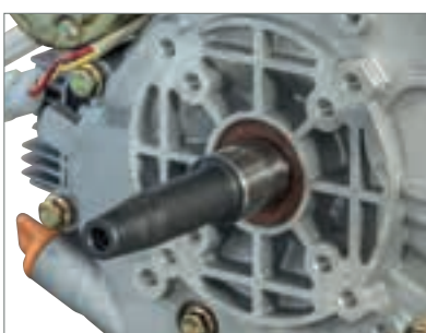
Albero lungo generatore Generator shaft
