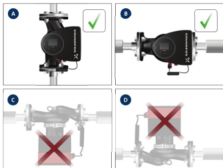
Siurblys turi būti sumontuotas taip, kad variklio velenas būtų horizontalus
