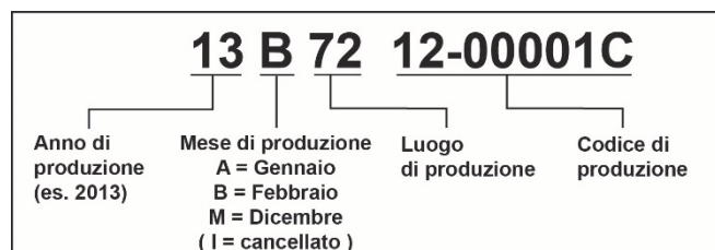
Figura 5-1: targhetta con dati di produzione
