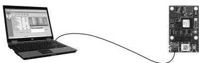
CIM 500 met Ethernet-kabel aangesloten op pc
