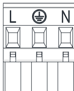
Slika 6: Snemljiva priključna sponka za priključitev napajanja
