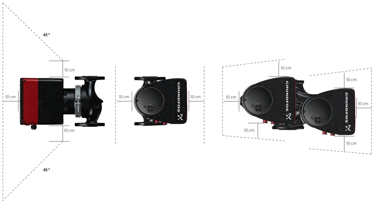
Minimalūs vienos ir dviejų galvų siurbliams reikalingi atstumai
