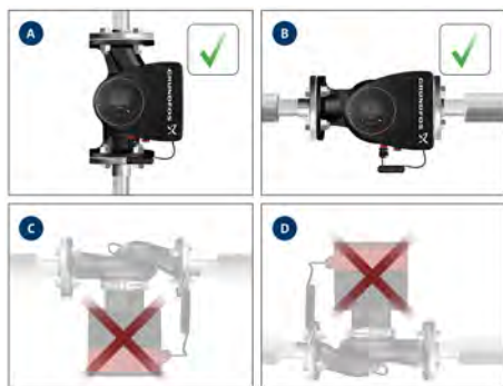
Siurblys turi būti sumontuotas taip, kad variklio velenas būtų horizontalus
